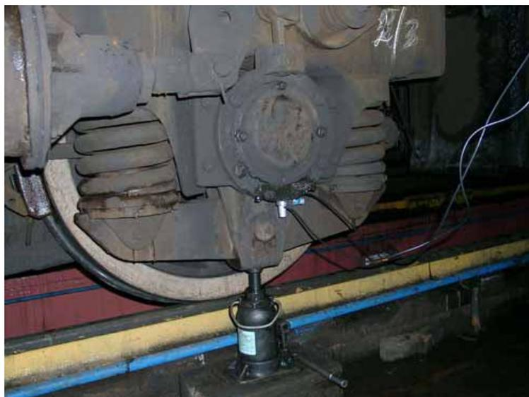
Рис.11. Общий вид буксового узла КРБ электропоезда ЭР2 с установленными датчиками
