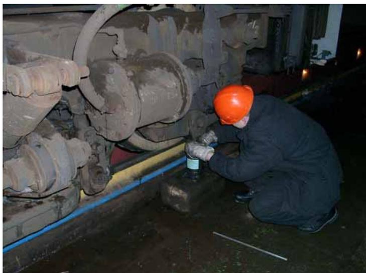
**Рис. 9. Вывешивание КРБ на гидродомкратах**
