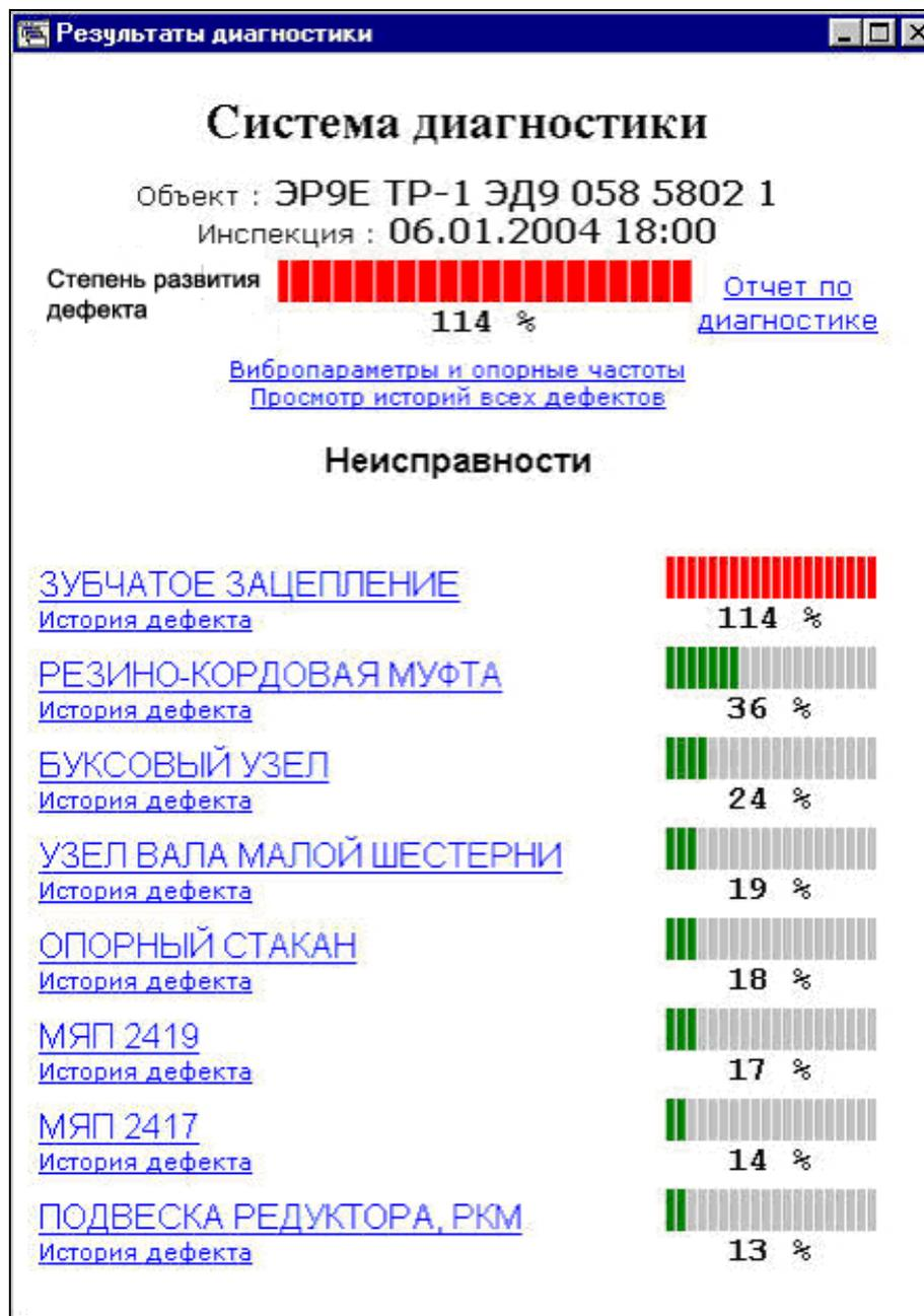
Рис. 17 Пример диагностического табло
