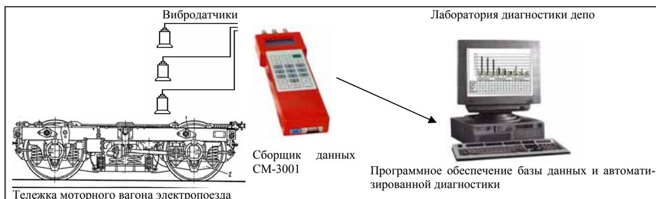
**Рис.1. Структурная схема применения диагностического комплекта на базе прибора СМ-3001 и программного обеспечения СУБД «АРМИД»**
